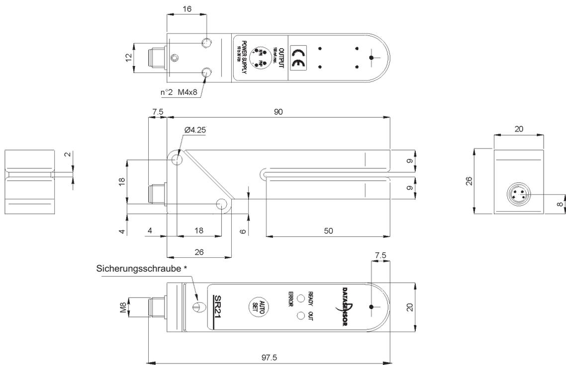
\* der Anschlussblock kann um 90° gedreht werden
